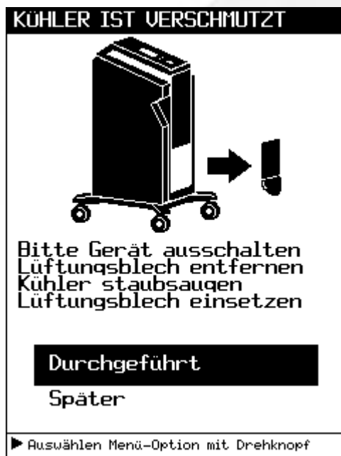
Bild 10: „Reinigung des Kühlers“
